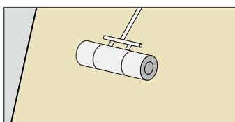
②45kg以上のローラーなどで中央から継ぎ目に向かって残った空気を押し出すように圧着します。
