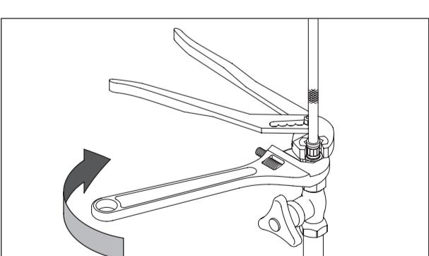
③ フレキシブルホースが動かないようにレンチ等で押さえながらナットをスパナー等で増し締めします。締め付けトルクは目安として 4 ~ 6N · m です。
