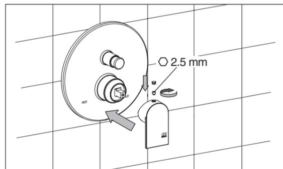
③レバーハンドルを差し込み、2.5mm の六角レンチで固定します。六角レンチの穴にネジキャップをはめます。
