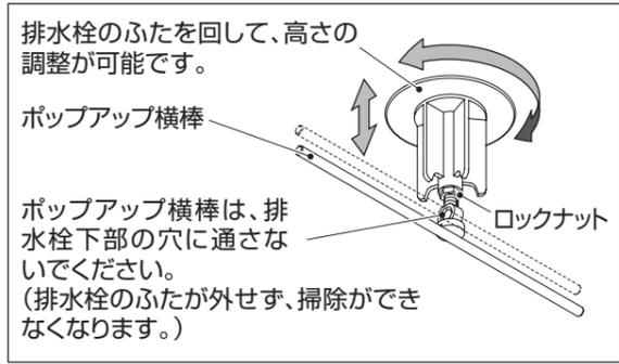
ポップアップ縦棒を下げ、排水栓のふたが上がったら、溜めた水がスムーズに排水されるよう高さを調整してください。(図C参照)
