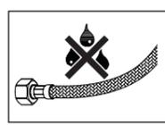
設置後のホースは、いかなる物質も接触し続ける状態にしないでください。ホースの損傷や破裂をまねく恐れがあります。
