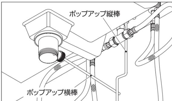
4 ポップアップ横棒取付穴がポップアップ縦棒の方を向くように、受け金具の向きを調整し、ポップアップ横棒を取り付けてください。
