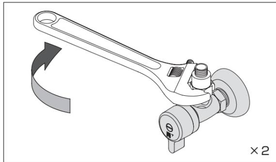
2 レンチまたはスパナーでしっかり締めます。(接続口径G1/2) 締め付けトルクの目安は10~15N・mです。
