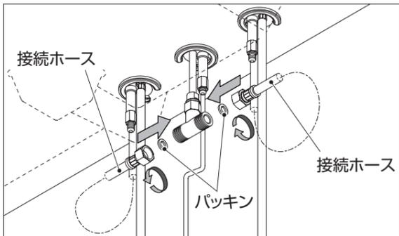
6 T型ジョイントに給水側、給湯側レバーハンドル接続ホースを取り付けます。
