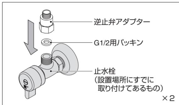
1 止水栓と逆止弁の間にG1/2用パッキンを入れ、逆止弁を手でしっかり締めます。
