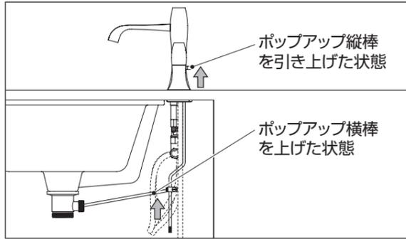
図Bの状態ユニバーサルジョイントの縦棒固定ネジ(図A参照)をドライバーでしっかり締めて、縦棒に固定してください。
