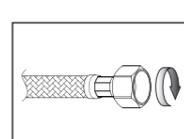
ナット付コネクターは手でしっかり締めつけてから、適合するレンチで締めつけてください。ゴムパッキンの場合は、締めすぎに注意してください。
