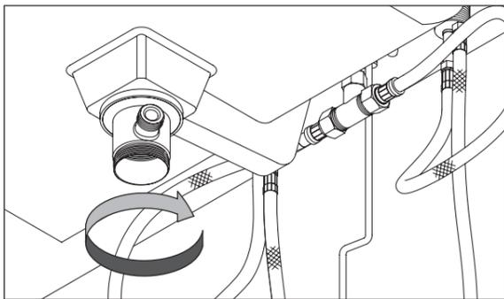
3 受け金具は手でしっかり締め付けた後、ウォーターポンプ等で増し締めしてください。
