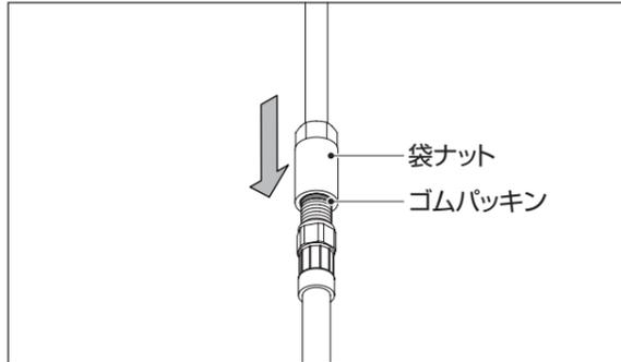
③ 手でしっかり締めた後、シャワーホースがよじれないようにスパナ等で押さえ、袋ナットを1/2～3/4回転増し締めします。締め足りなかったり、締めすぎると水漏れの原因となります。
