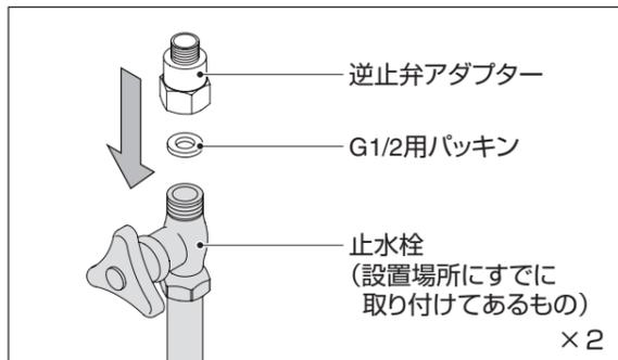
① 止水栓と逆止弁の間に G1/2 用パッキンを入れます。
