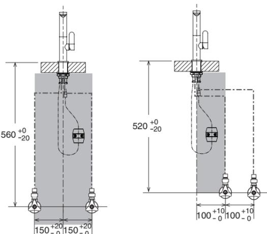
給水管、給湯管がシャワーホース、シャワーホース用重り、及び排水トラップとの干渉を避けるため、各止水栓は下図に従って配置してください。
