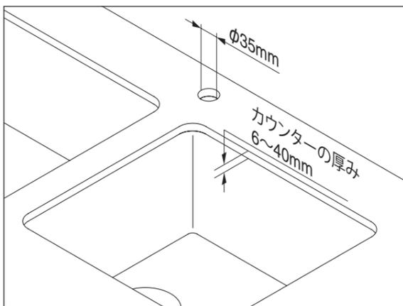
水栓取付穴とカウンターの厚みが適合していることを確認してください。
