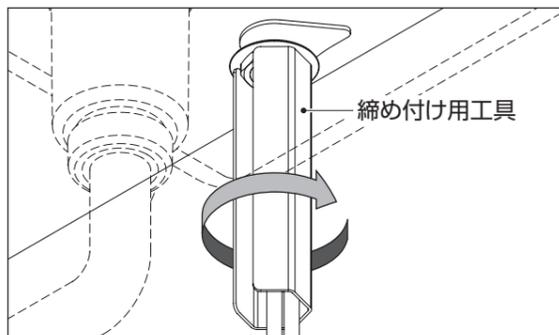
④付属の締め付け用金具でナットを締めます。
