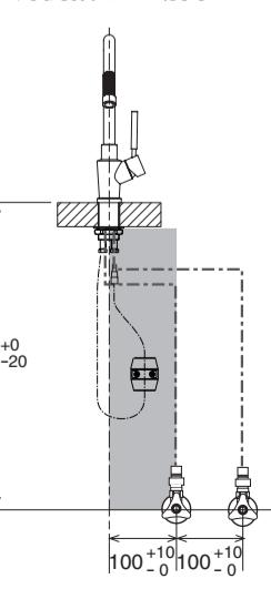
給水管、給湯管がシャワー ホース、シャワー ホース用重り、及び排水トラップとの干渉を避けるため、各止水栓は下図に従って配置してください。
