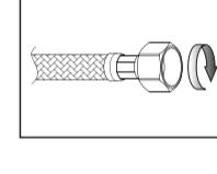
ナット付コネクターは手でしっかりと締めつけてから、適合するレンチで締めつけてください。ゴムパッキンの場合は、締めすぎに注意してください。
