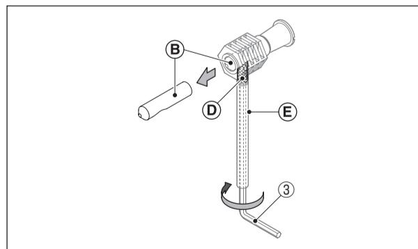
※ロングナットⒷは、付属の締め付け用六角レンチ③を延長パイプⒺから挿入し、反時計回りに回して洗面固定用イモネジⒹを緩めて外してください。
