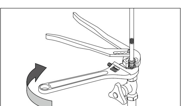
③ フレキシブルホースが動かないようにレンチ等で押さえながらナットをスパナー等で増し締めします。締め付けトルクは目安として(シートパッキン) 5 ~ 7N · m です。
