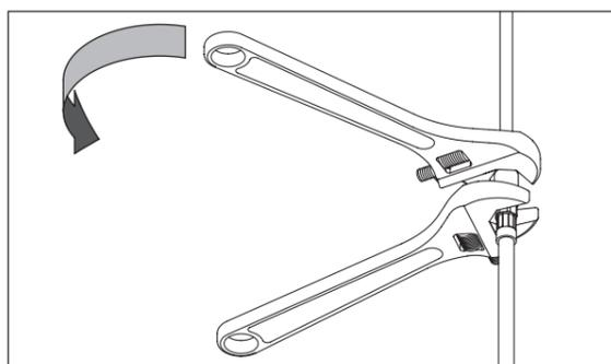
②手でしっかり締めた後、シャワーホースがよじれないようにスパナ等で押さえ、袋ナットを1/2～3/4回転増し締めします。締め足りなかったり、締めすぎると水漏れの原因となります。
