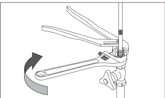
③ フレキシブルホースが動かないようにレンチ等で押さえながらナットをスパナ等で増し締めします。締め付けトルクは目安として (シートパッキン) 5～7N・m です。
