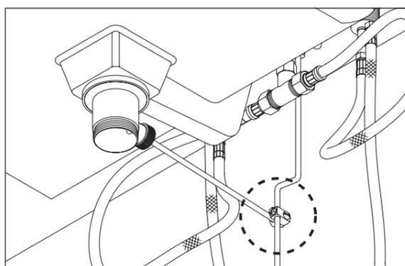
ポップアップ縦棒とポップアップ横棒をユニバーサルジョイントで接続します。ユニバーサルジョイントの接続は、図Aのように、ポップアップ横棒を太い穴に、ポップアップ縦棒を細い穴に差し込み、排水栓を閉めた状態でネジを締め、固定してください。作業が終わったら、動作を確認してください。
