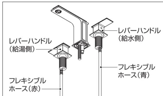
① 給水側、給湯側それぞれのハンドルに接続されているホースにゆるみがないよう、手締めで時計回りに回して締め込みます。
