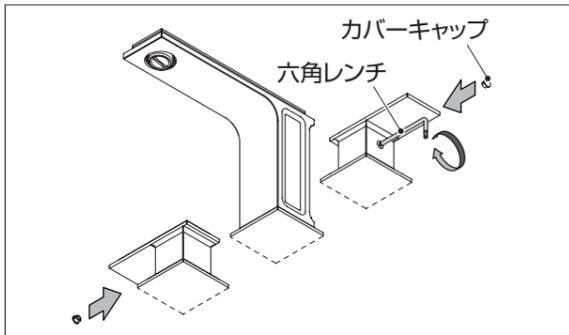
⑦ 六角レンチでレバーハンドルの止めねじを締め込んで固定した後、付属のカバーキャップをねじ穴に差し込んでください。
