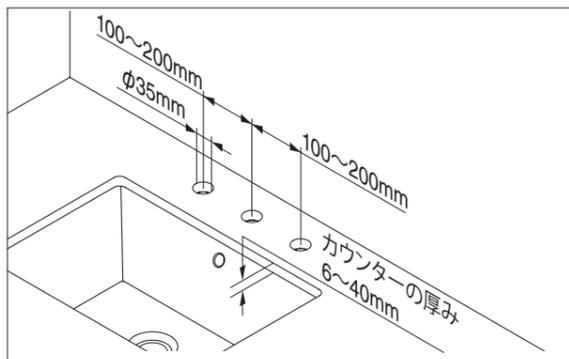
水栓取付穴とカウンターの厚みが適合していることを確認してください。
