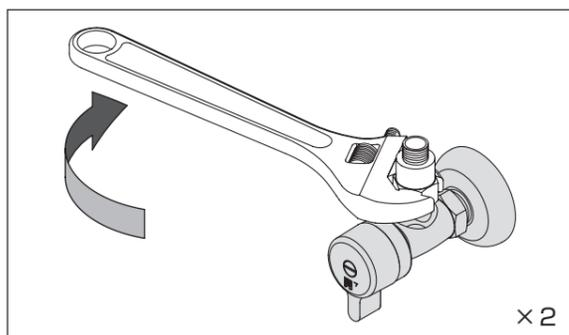
② レンチまたはスパナーでしっかり締めます。(接続口径 G1/2) 締め付けトルクの目安は 10 ~ 15N・m です。
