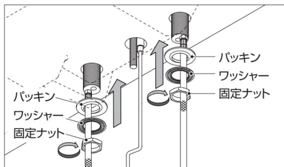
④ ハンドル取付金具を下からパッキン、ワッシャー、固定ナットの順に給湯、給水ホースに通し、固定ナットでしっかり締めます。※パッキンは、カウンター裏面に完全に接するまで手で上げてください。
