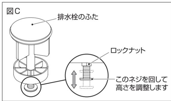
ポップアップ縦棒を下げ、排水栓のふたが上がったら、溜めた水がスムーズに排水されるよう高さを調整してください。(図C参照)
