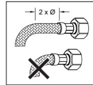
ホースを曲げる場合は、ホース差し込み口からパイプの外径の約2倍の長さ以上の直線部分を維持してください。
