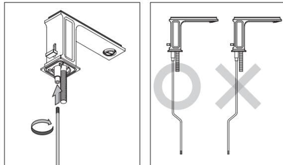
② ポップアップ縦棒を水栓本体にねじ込みます。ポップアップ縦棒の向きに注意してください。(左図参照)
