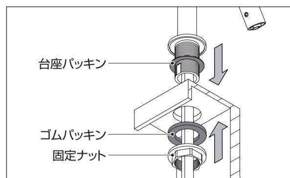
① 水栓本体の台座に台座パッキンをはめ、水栓取付穴に全体を差し込みます。
