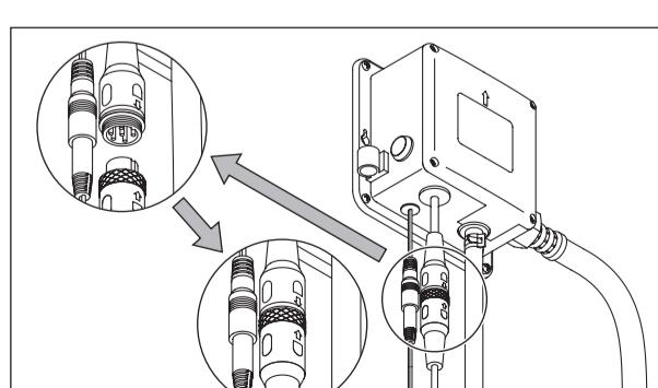
④ 誤作動を起こした場合や、センサーが反応する距離を変更したい場合は、一度センサーケーブルを抜き接続し直してから設定を行なってください。
