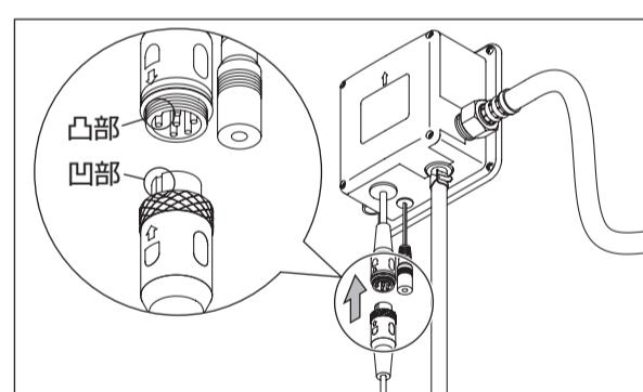
⑤ コントロールボックスのコネクタ（6芯）に水栓本体のセンサーケーブルを接続します。
