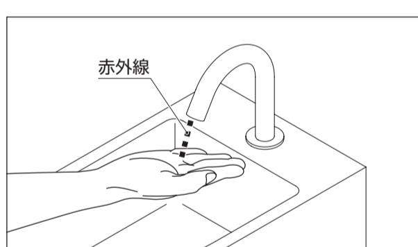
② 初期設定ボタンを長押ししている間に、反対側の手でセンサーを反応させたい一番遠い位置に手をかざし、固定します。
