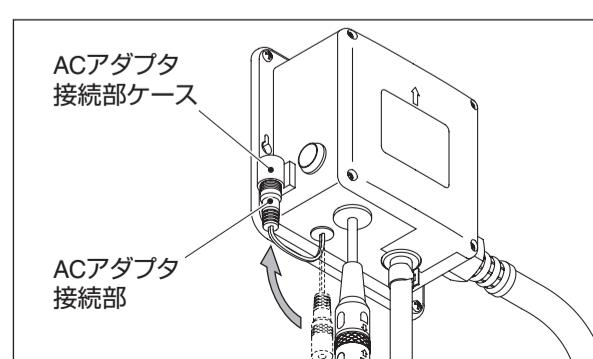
※ DC（電池）で作動させる場合、AC アダプター接続部はケースに差し込んでください。
