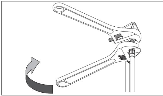
③手でしっかり締めた後、シャワーホース接続ナットをスパナ等で押さえ、シャワーホースがよじれないようにシャワーホース上部を1/2～3/4回転増し締めします。締め足りなかったり、締めすぎると水漏れの原因となります。
