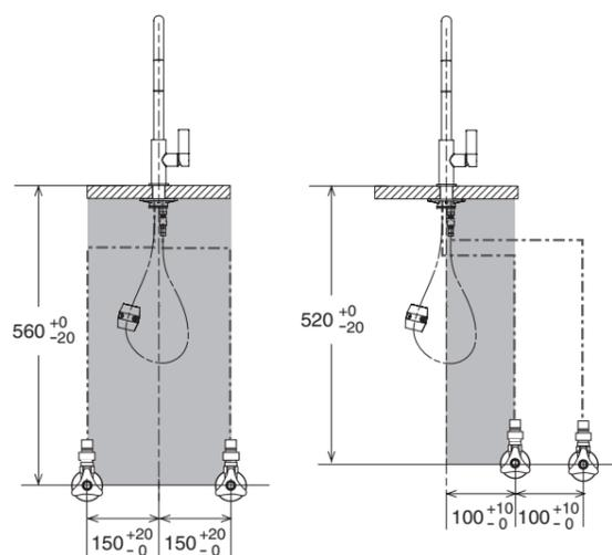
給水管、給湯管がシャワーホース、シャワーホース用重り、及び排水トラップとの干渉を避けるため、各止水栓は下図に従って配置してください。
