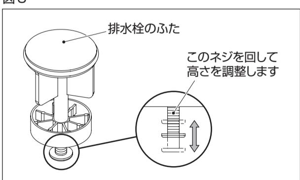
ポップアップ操作棒を下げる、排水栓のふたが上がったら、溜めた水がスムーズに排水されるよう高さを調整してください。（図C参照）
