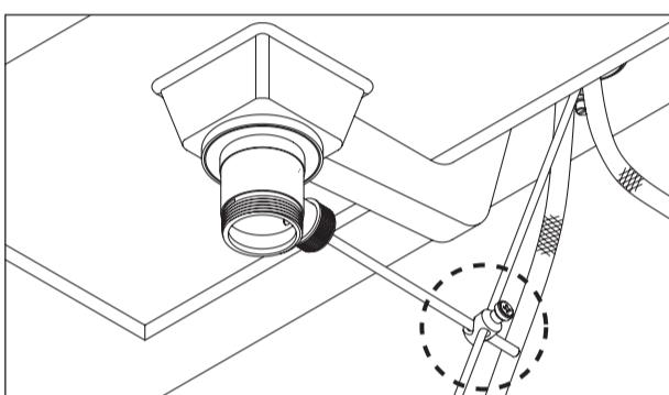
ポップアップ操作棒とポップアップ横棒をユニバーサルジョイントで接続します。ユニバーサルジョイントの接続は、図Aのように、ポップアップ横棒を太い穴に、ポップアップ操作棒を細い穴に差し込み、排水栓を閉めた状態でネジを締め、固定してください。
