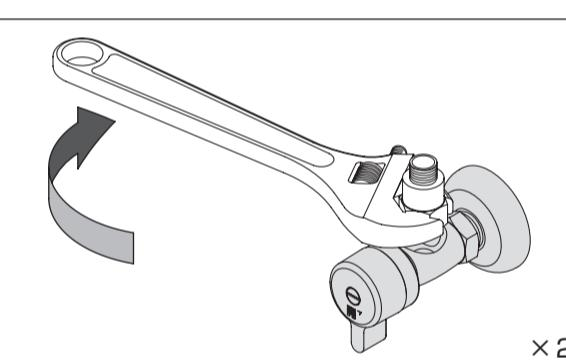
② レンチまたはスパナーでしっかりと締めます。（接続口径 G1/2）締め付けトルクの目安は 10～15N·m です。
