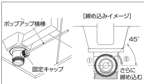
④ 下部排水栓金具にポップアップ横棒を取付けます。固定キャップを止まるまで締めた後①、さらに45°程度締め込んでください②。
