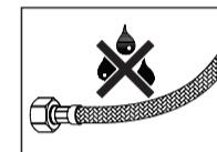
設置後のホースは、いかなる物質も接触し続ける状態にしないでください。ホースの損傷や破裂をまぬく恐れがあります。
