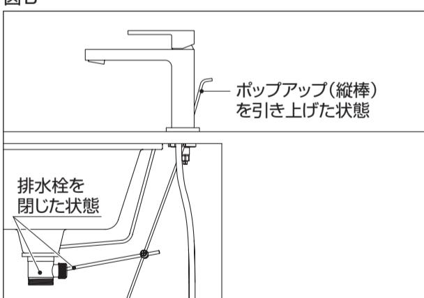
図Bの状態でユニバーサルジョイントの操作棒固定ネジ（図A参照）を操作棒が外れない程度に締めてください。
