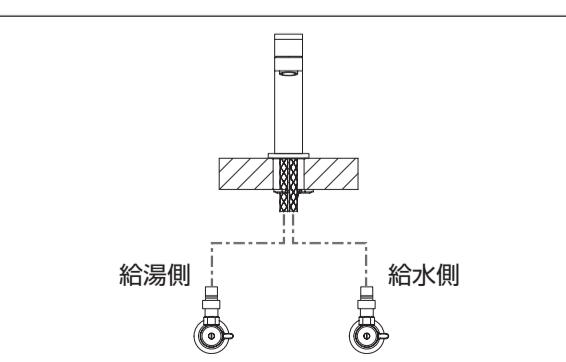
① 水栓本体の正面から向かって左側のフレキシブルホースを給湯側に、右側を給水側に接続してください。
