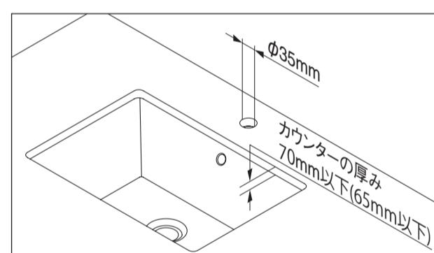
水栓取付穴とカウンターの厚みが適合していることを確認してください。
