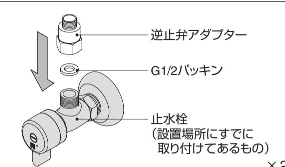
① 止水栓と逆止弁の間にG1/2パッキンを入れ、逆止弁を手でしっかりと締めます。
