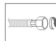
ナット付コネクターは手でしっかりと締めつけてから、適合するレンチで締めつけてください。ゴムパッキンの場合は、締めすぎに注意してください。
