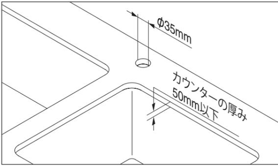
水栓取付穴とカウンターの厚みが適合していることを確認してください。
