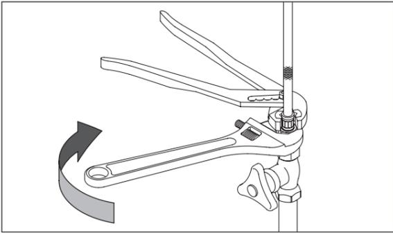
③ フレキシブルホースが動かないようにレンチ等で押さえながらナットをスパナ等で増し締めします。締め付けトルクは目安として4～6N・mです。
