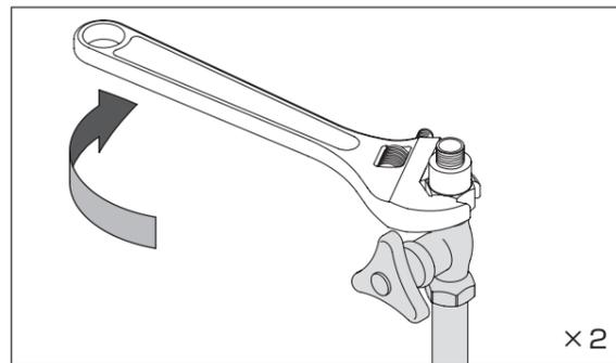
②レンチまたはスパナーでしっかり締めます。(接続口径 G1/2) 締め付けトルクの目安は 10 ~ 12N・m です。
