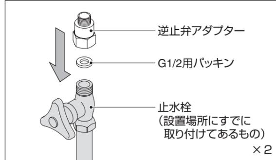
①止水栓と逆止弁アダプターの間にG1/2用パッキンを入れ、逆止弁アダプターを手でしっかり締めます。
