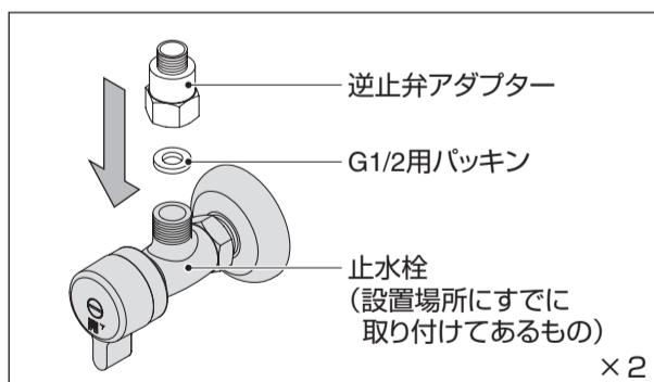
① 止水栓と逆止弁の間にG1/2用パッキンを入れ、逆止弁を手でしっかりと締めます。
