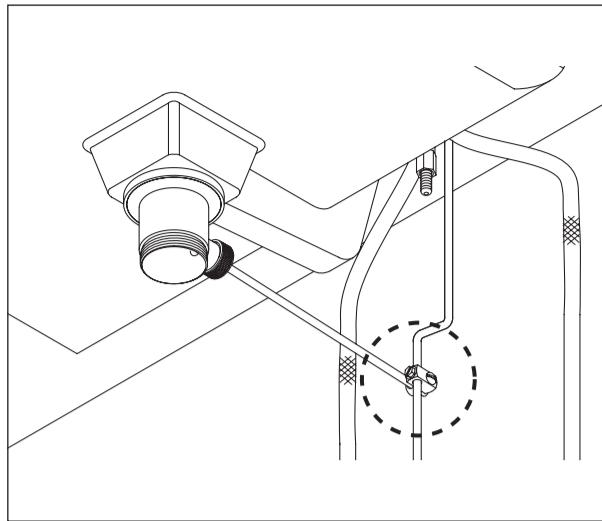
ポップアップ縦棒とポップアップ横棒をユニバーサルジョイントで接続します。ユニバーサルジョイントの接続は、図Aのように、ポップアップ横棒を太い穴に、ポップアップ縦棒を細い穴に差し込み、排水栓を閉めた状態でネジを締め、固定してください。
