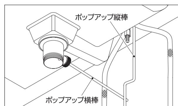
④ポップアップ横棒取付穴がポップアップ縦棒の方を向くように、受け金具の向きを調整し、ポップアップ横棒を取り付けてください。
