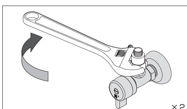
② レンチまたはスパナーでしっかりと締めます。（接続口径G1/2）締め付けトルクの目安は10～15N·mです。
