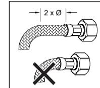
ホースを曲げる場合は、ホース差し込み口からパイプの外径の約2倍の長さ以上の直線部分を維持してください。
