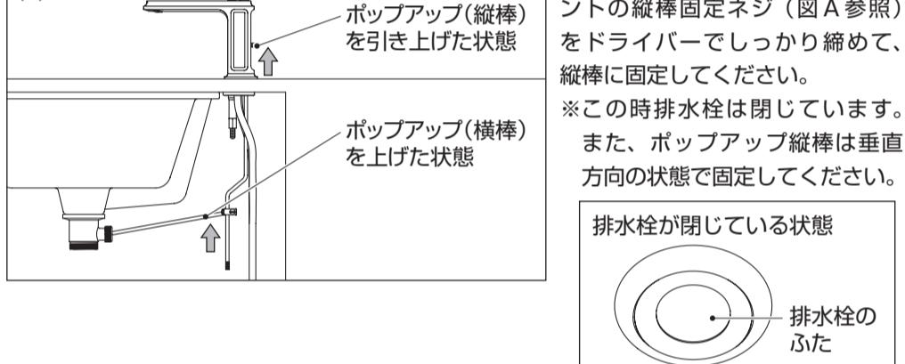
図Bの状態でユニバーサルジョイントの縦棒固定ネジ（図A参照）をドライバーでしっかりと締めて、縦棒に固定してください。
