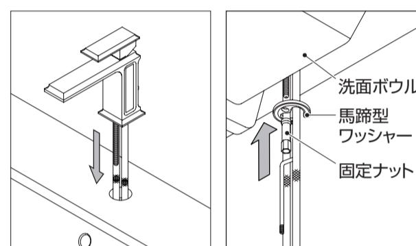
③ホース、ポップアップ縦棒を取り付け穴に差し込みます。水栓の向きを正しい位置にして、下から馬蹄形ワッシャーをあて、固定ナットで水栓全体がぐらつかないようにしっかりと締めます。
