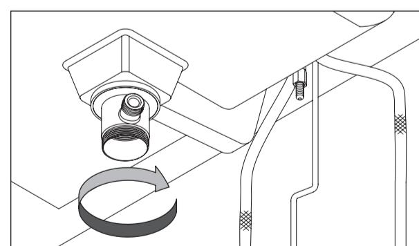
③受け金具は手でしっかりと締め付けた後にウォーターポンプ等で増し締めします。
