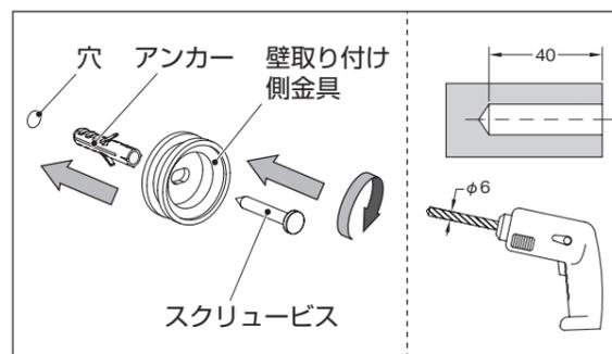
② ①で付けた印の位置にφ6mm 深さ40mmの穴を開けます。穴にアンカーを挿入後、スクリュービスを使用して壁掛け固定金具の壁取り付け側金具を固定します。
