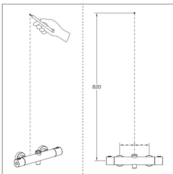
① 壁掛け固定金具取り付け用の穴位置に印を付けます。
