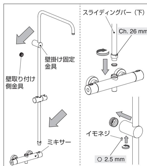
⑤ スライディングバー（下）をミキサーにねじ込んだ後、壁取り付け側金具に壁掛け固定金具を差し込みイモネジで固定します。
