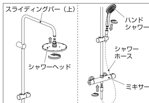
⑥ スライディングバー（上）にシャワーヘッドを取り付けます。ミキサーにシャワーホースを取り付けます。シャワーホース反対側にハンドシャワーをねじ込んで取り付けます。
