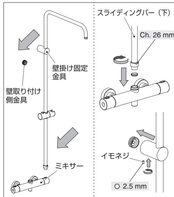
⑤ スライディングバー（下）をミキサーにねじ込んだ後、壁取り付け側金具に壁掛け固定金具を差し込みイモネジで固定します。
