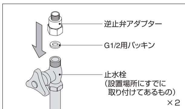
① 止水栓と逆止弁の間にG1/2用パッキンを入れます。
