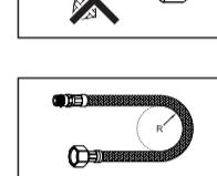
ホースを曲げる場合は、ホース差し込み口からパイプの外径の約 2 倍の長さ以上の直線部分を維持してください。
