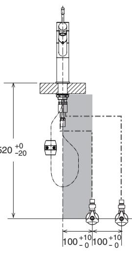
給水管、給湯管がシャワーホース、シャワーホース用重り、及び排水トラップとの干渉を避けるため、各止水栓は下図に従って配置してください。
