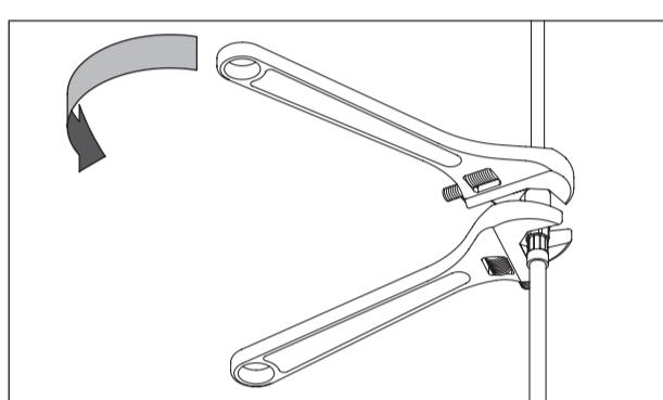
③ 手でしっかりと締めた後、シャワーホースがよじれないようにスパナ等で押さえ、袋ナットを1/2回転(180°)増し締めします。締め足りなかったり、締めすぎると水漏れの原因となります。
