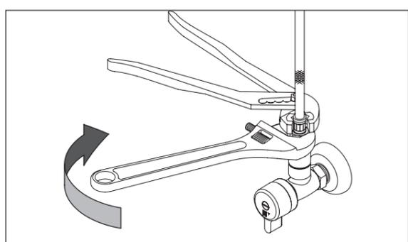
③ フレキシブルホースが動かないようにレンチ等で押さえながらナットをスパナー等で増し締めします。締め付けトルクは目安として 5 ~ 7N・m です。
