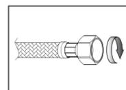
ナット付コネクターは手でしっかり締めつけてから、適合するレンチで締めつけてください。ゴムパッキンの場合は、締めすぎに注意してください。
