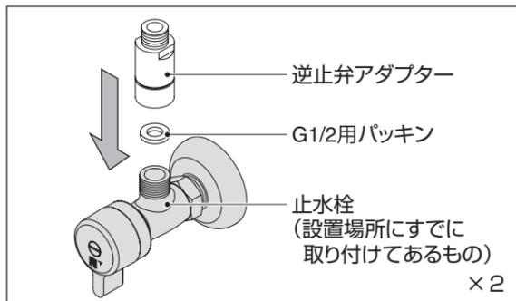
① 止水栓と逆止弁の間に G1/2 用パッキンを入れ、逆止弁を手でしっかり締めます。
