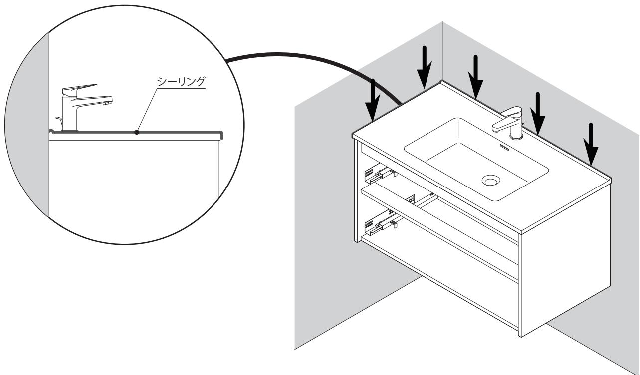
キャビネット設置後、必ずカウンターと壁をシリコーン系シーリング材で埋めてください。
