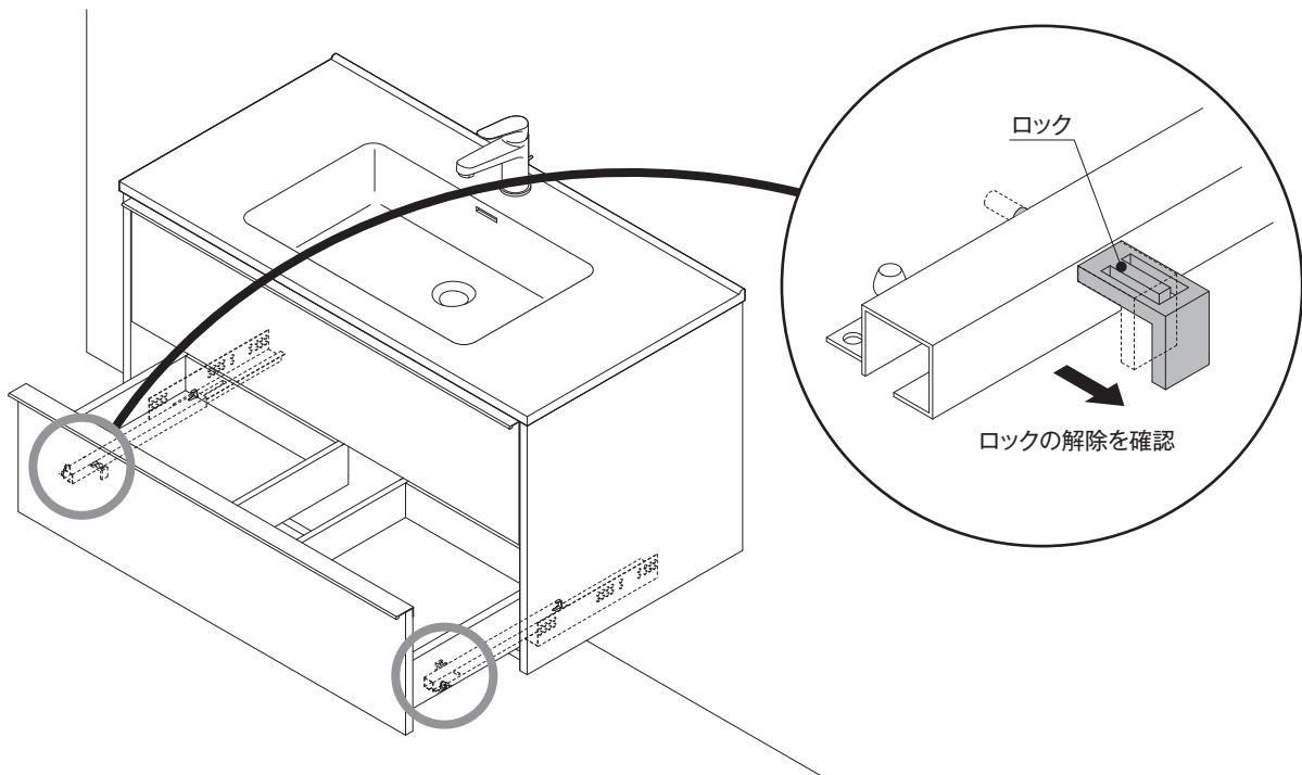
3. レール手前側の突起に引出し底部の穴を差し込む。
