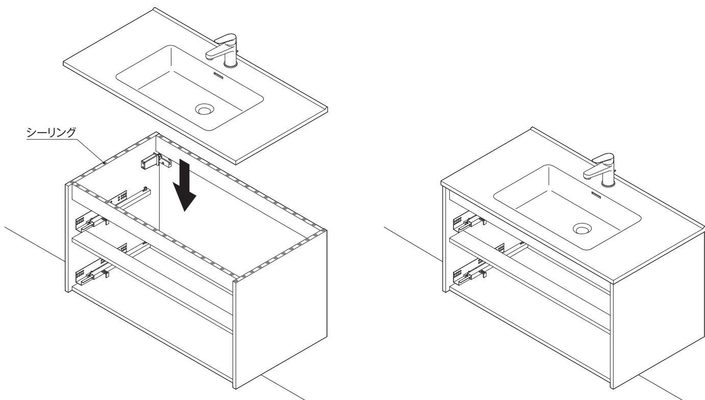
2. キャビネット設置後、カウンターと壁をシリコーン系シーリング材で埋める。
